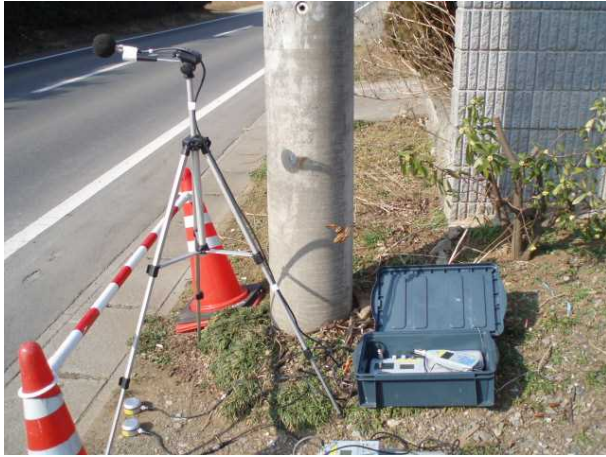
実施例：騒音・振動の測定状況
