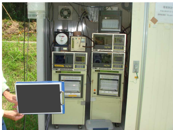
実施例：窒素酸化物( \text{NO}_x )、浮遊粒子状物質 (SPM) の測定状況
