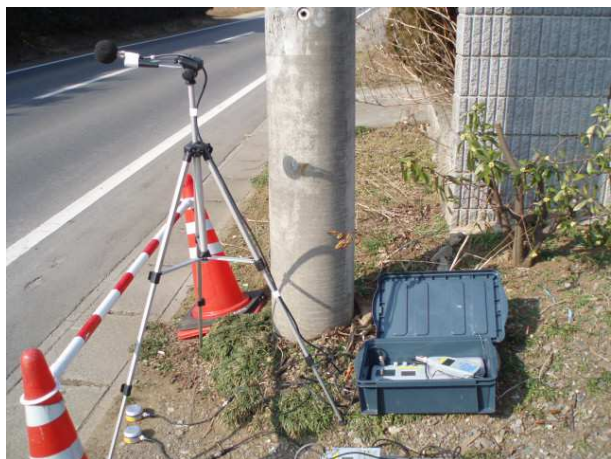
実施例：騒音・振動の測定状況
