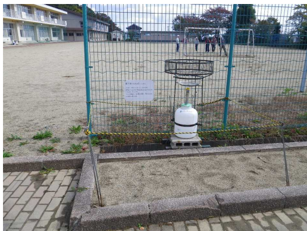
実施例：粉じんの測定状況
